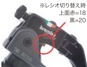
※ラバーキャップを外し マイナスドライバー等を使用し 18or 20に設定
