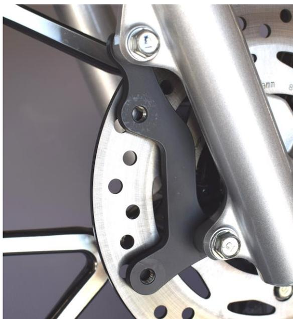
④キャリパーを③で仮止めしたキャリパープレートに付属のキャリパーカラーを挟み、付属の M8-22GAP ボルトで仮止めして下さい。この際、キャリパーがローターのセンターになるよう必要に応じて付属の M8 シムをキャリパーとキャリパーカラーの間に挟んで調整して下さい。
